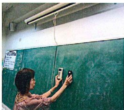
使用數位照度計測照明
